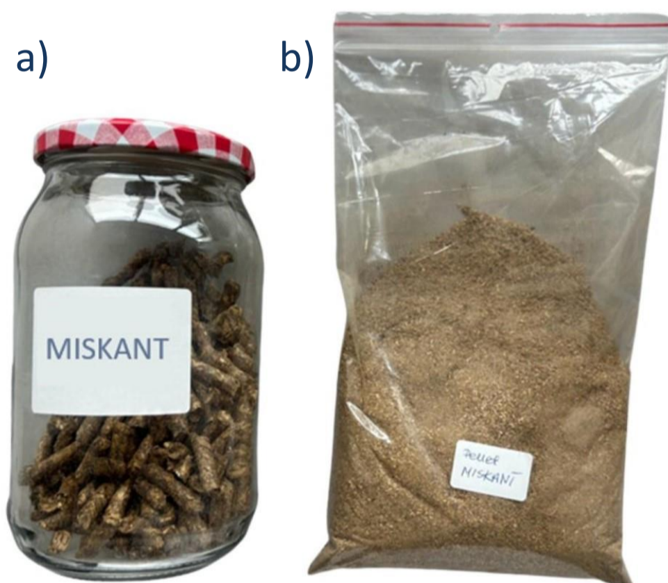
Rys 2. Analizowany materiał a) pellet z miskanta, b) pellet z miskanta po homogenizacji na młynach nożowych.
